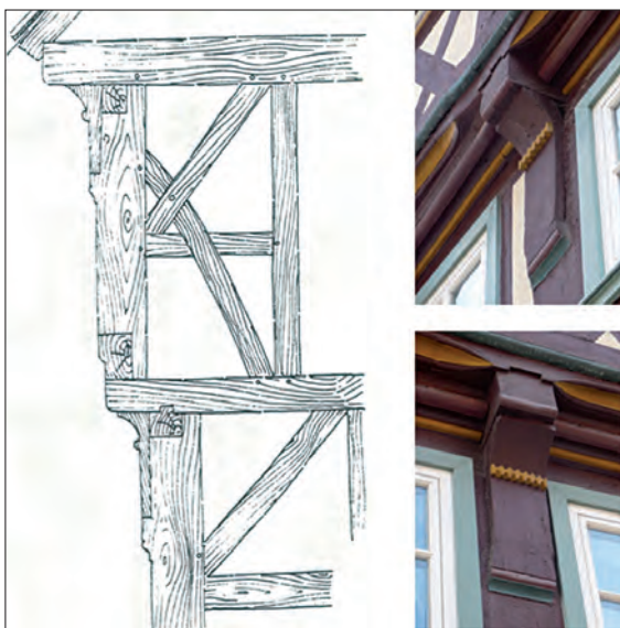
Abb. 10: Beibehaltung der Ständerausführung mit ausgearbeitetem Vorsatz für Konsolaufleger. Links: Detailschnittdarstellung von Rassow; rechts oben und unten: Details der erhaltenen Ausführung in der Windischen Gasse 46. Fotos: K. A. Heidenblut.
